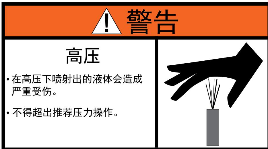
当所有排放或排水管路关闭时，不要进行操作。否则将产生高压，损坏泡沫系统及其组件。
